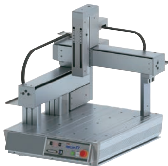
※2 Cタイプ: ワーク固定タイプ ワークをベースに積載して使用するタイプ
