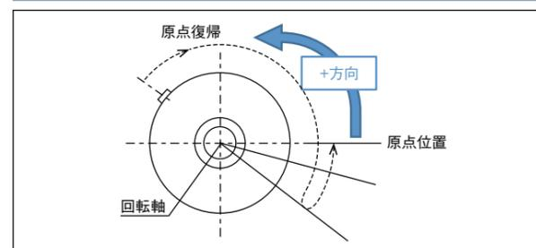
回転部先端から見て、反時計方向の回転が+方向になります。
