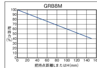
(注) 最大把持力を100%とした時の張出し位置による把持力を示しています。使用するフィンガーアタッチメントの剛性により結果が異なる可能性があります。
