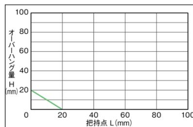
(注) 制限範囲を超えた場合はフィンガー振動部および内部メカに過大なモーメントが作用して、寿命に悪影響を及ぼす原因となります。
