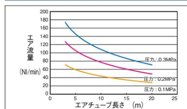
(注) 外径6mm・内径4mmのエアチューブに対する相関図となります。製品側は外径: 6の継ぎ手を使用しています。
