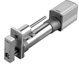
タイプ / ロッド(幅58mm) シングルガイド付    ストローク / 50~300mm    可搬質量 / 水平40kg/垂直18kg
