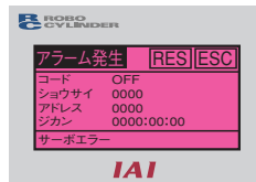
アラーム発生時 (ピンク)
